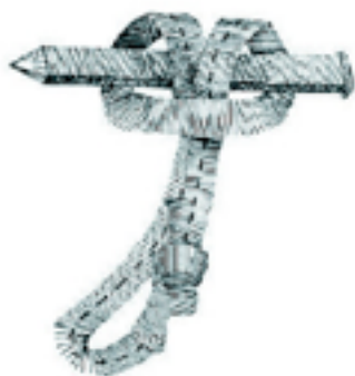
Figur 29. Slyngstik. Anvendes bl.a. til at binde to slynger sammen med.
