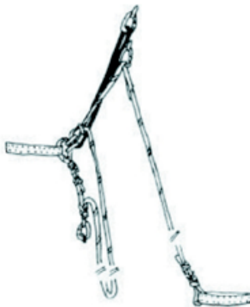
Figur 15. Sikring fra standplads
