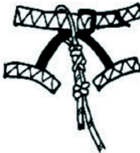
Figur 2. Indbindingspunkt. Ottetalsknode og stopknode
