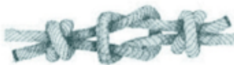
Figur 27. Råbåndsknob. Anvendes til at binde to reb sammen med.
