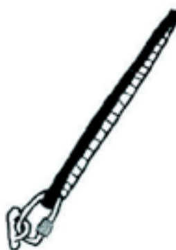
Figur 3 b. Andet eksempel på bundsikring. Slynge fæstet med slyng-stik til fastboltet stålring i gulvet.
